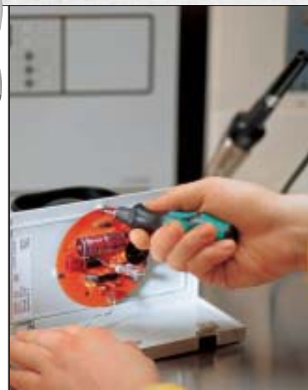
Система крепежа TRI-WING® применяется в аэрокосмической промышленности и в бытовой технике.
