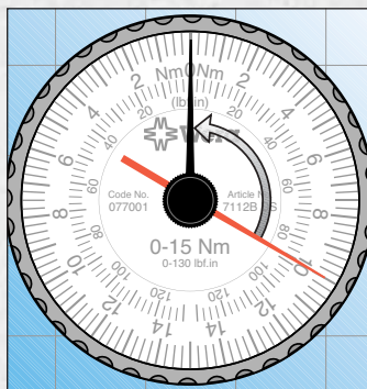
Шкала после снятия нагрузки (красная стрелка показывает значение приложенного момента затяжки - 10 нМ)
